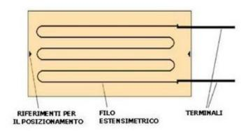
Filo conduttore su supporto isolante allungabile o restringibile; converte le variazioni di lunghezza in variazioni di resistenza
